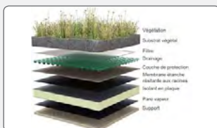
Étanchéité et isolation par jardin
