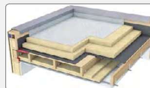
Étanchéité sur solives
