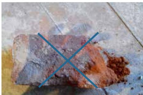
Les briques doivent être résistantes au gel et suffisamment solides : elles ne s'effritent pas à la main, ne se cassent pas au nettoyage, et ne sont pas trop poreuses (son lourd quand on les heurte l'une sur l'autre).
