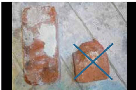
**4** Éliminez les briques d'un format inférieur à une demi-brique. Les briques  $\frac{3}{4}$  et  $\frac{1}{2}$  sont autorisées en petite quantité. Le pourcentage de brique incomplète dans un lot doit être connu avant revente.
